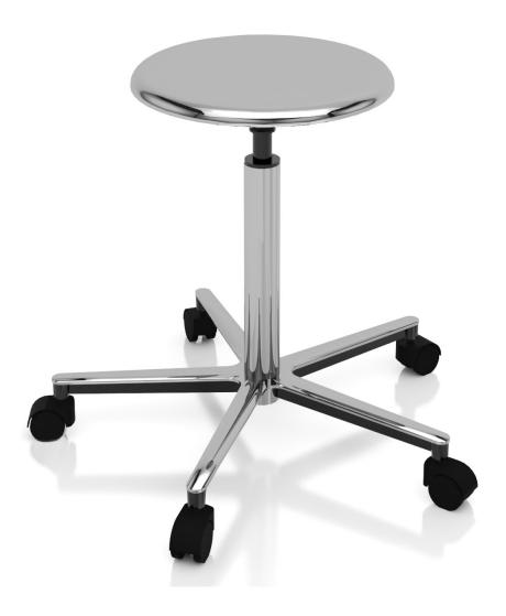
**Art. 108317** Sgabello ambulatoriale ad elevazione a vite con sistema di sicurezza a fine corsa. Base e sedile in alluminio pressofuso, colonna di sollevamento in acciaio cromato. 5 ruote in polimero Ø 50 mm gemellate.
